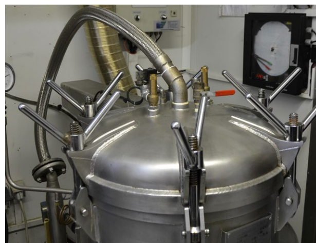
Autoclave avec pompe de recyclage, système de régulation et enregistrement à disque
